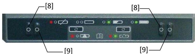
3. Полная зарядка батареи занимает несколько часов. Когда батарея будет полностью заряжена, зеленый СИД ([9]), будет гореть непрерывно (см. также напечатанную инструкцию к зарядному устройству).
